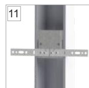
11 Elementy wzmacniające konstrukcję ościeżnicy z kotwami montażowymi
