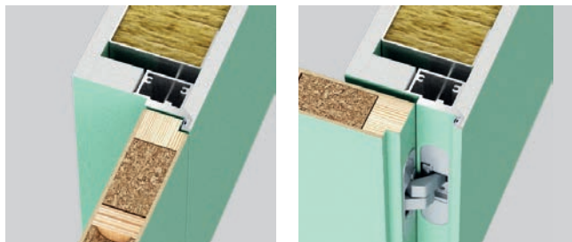
Odrotna przylga (otwierane do wewnątrz) - drzwi lewe
